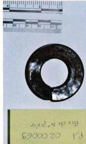
o. Scelle N°P1 0200069 : rondelle GROWER
