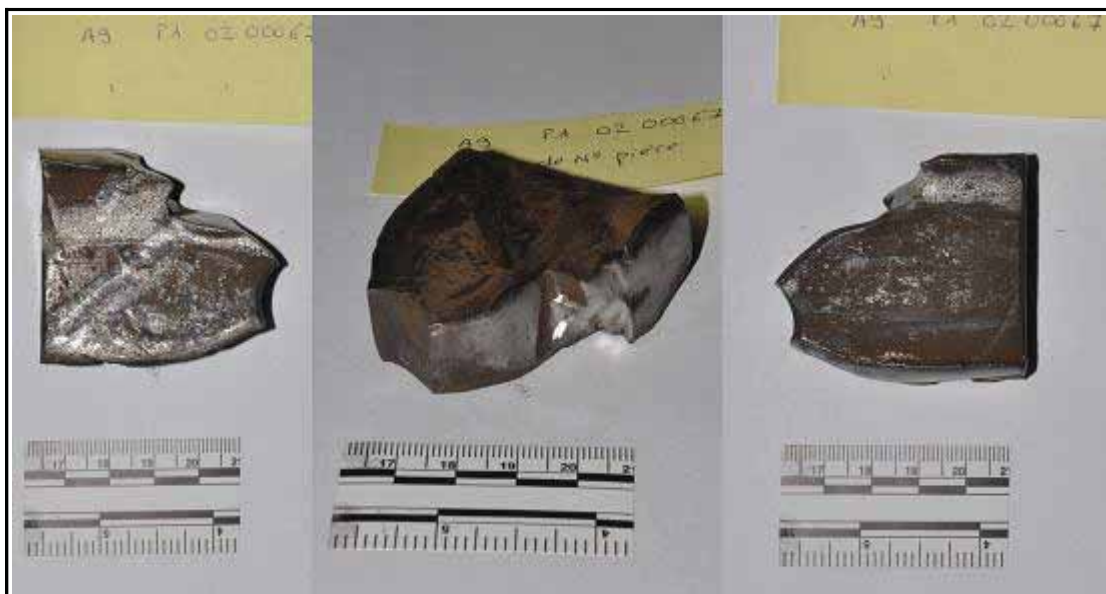
Figure 38 : Morceau de l'about rompu du cœur de traversée
