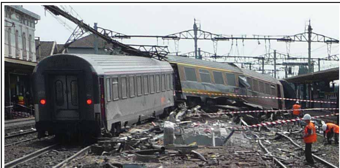
Figure 1 : Vue des trois dernières voitures déraillées
